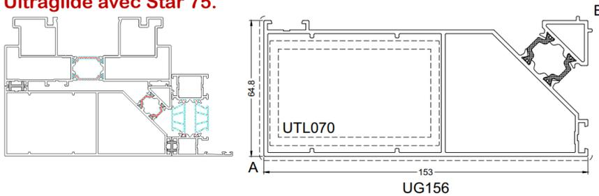
Profile de raccordement au sol.
