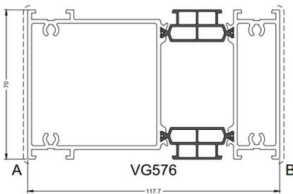
Profile de raccordement 90° VG500 avec 2 rails avec Star 75.
