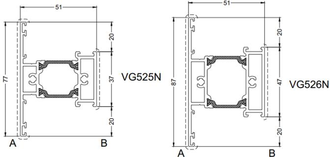
Profile de raccordement pour VG500 avec 2 rails.
